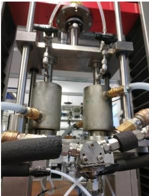
Abbildung 1: Fällungsanlage mit dem Mikromischer im Vordergrund.
