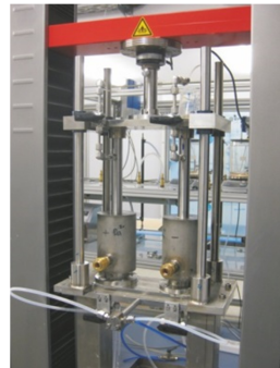
Abbildung 2: Spritzenpumpenanlage mit Mischdüse für die Fällungskristallisation
