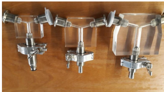
Abb. 1: Neue Anlage für modulare stationäre Fällprozesse (links) und Beispiele für Reaktormodule(rechts)
