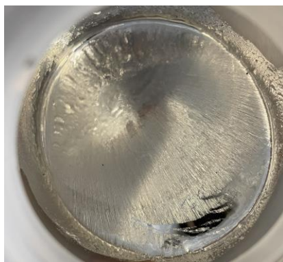
Abbildung 1: Flüssiges, nah-eutektisches GaInSn bei Raumtemperatur (links) und Querschnitt der Messstrecke mit Heizsegmenten und Thermoelementen (rechts).
