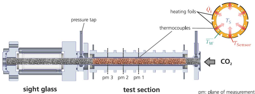
Im Rahmen Arbeit soll der Einfluss der Einlauflänge und der Zellgröße auf die Charakteristika des Strömungssiedens in Kupferschwämmen, die in ein horizontales Verdampferrohr integriert wurden, untersucht werden.
