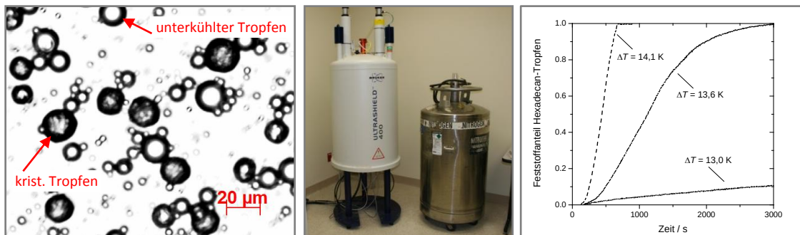
Abbildung 1: V.l.n.r.: Schmelzemulsion mit unterkühlten und kristallisierten Tropfen; NMR-Messgerät zur Bestimmung des kristallinen Anteils in Emulsionen; gemessener kristalliner Anteil von Schmelzetropfen über der Zeit (=Kristallisationsrate) bei unterschiedlichen Unterkühlungen \Delta T . Wie verändert sich dieser Anteil unter Scherung infolge von Kollision und Partikel/Tropfenwechselwirkungen im Vergleich zu unbewegten Schmelzemulsionen?
