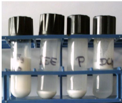
Abbildung 42: Von links nach rechts 1,5 g MFO mit jeweils 16 ml Wasser, Diethylether (DEE), Pentan (P), Dichlormethan (DCM) versetzt
