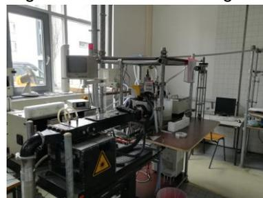
**Abbildung 1: Möglicher Aufbau der Raman-Spektroskopie-Methode, das Konzentrationsprofil kann in y-Richtung untersucht werden (links). Rechts: Raman-Trocknungskanal.**
