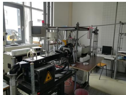
Abbildung 1: Aufbau der Raman Spektroskopie Methode, das Konzentrationsprofil kann in z-Richtung untersucht werden (links). Rechts: Raman Labor
