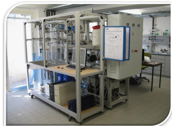
Abbildung 2: Fällungsanlage
