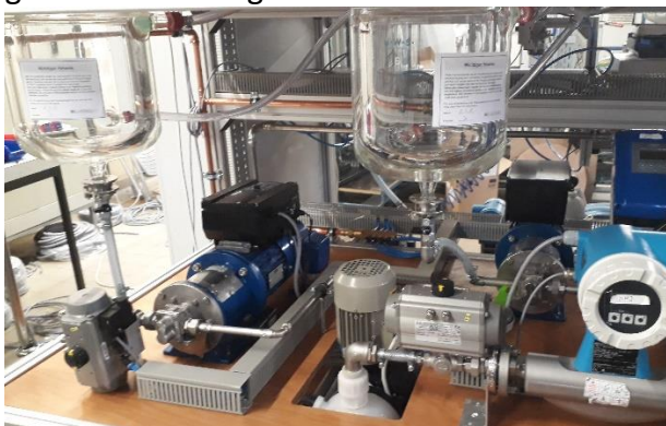
Abb. 1: Neue Anlage für instationäre Nanopartikelsynthese (links) und Leitsystem (rechts)
