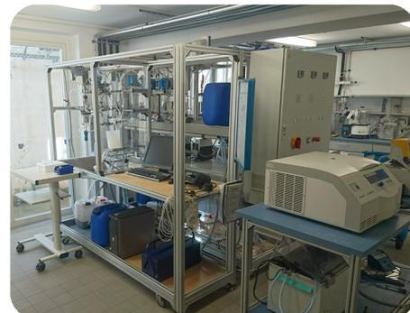
**Abbildung 2: Bestehende Kristallisationsanlage**
