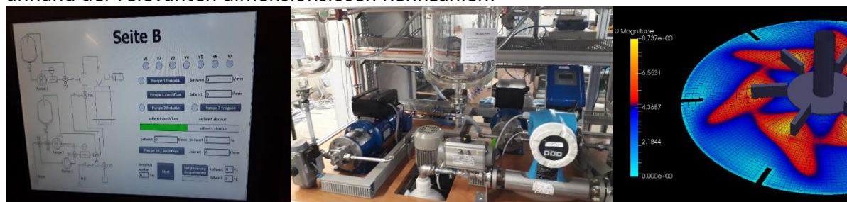
Abb. 1: SPS-Leitsystem der Fällungskristallisationsanlage (links), Ausschnitt von Anlage mit Edukt tanks und Feedzufuhr (Mitte), CFD-Simulation von Rührkesselreaktor (rechts).
