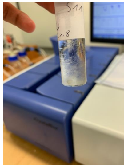
Abbildung 1: Links: Phasendiagramm des Systems \text{Na}_2\text{SO}_4\text{-Na}_2\text{CO}_3\text{-H}_2\text{O} bei 25 °C mit bestimmten metastabiler Grenze. Rechts: Natriumsulfatkristalle nach Kristallisation (Bildquellen: Bachelorarbeit Richard Samman).
