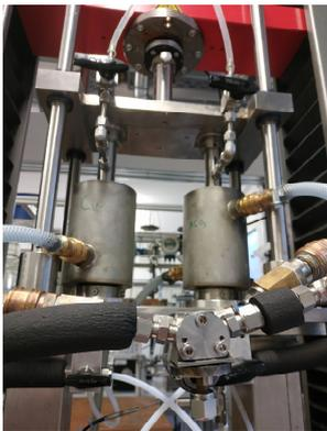
Abbildung 1: Fällungsanlage mit dem Mikromischer im Vordergrund.
