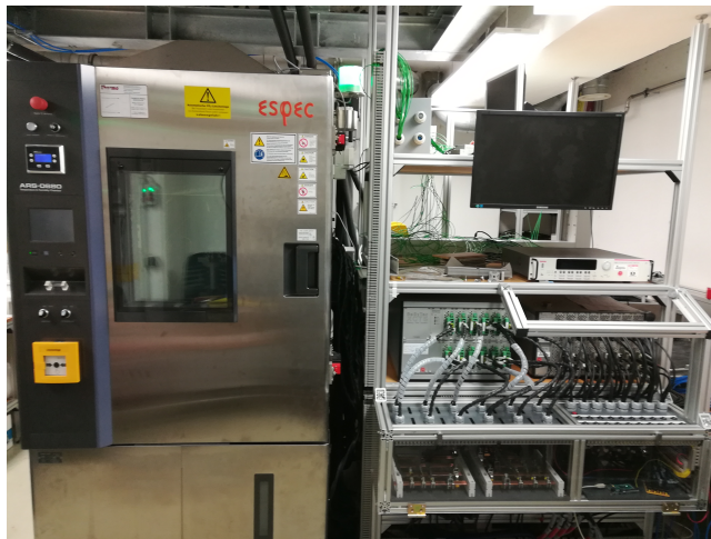
Abbildung 1: Beispiel für einen Versuchstand zur Untersuchung von LIB.
