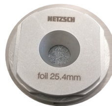
Abbildung 1: Links: Laser Flash Messgerät, Mitte: Probenhalterung für die LFA-Messungen, rechts: Schematische Darstellung eines Elektrodenstacks mit poröser Beschichtung.
