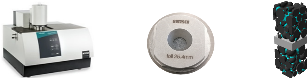
Abbildung 1: Links: Laser Flash Messgerät, Mitte: Probenhalterung für die LFA-Messungen, rechts: Schematische Darstellung eines Elektrodenstacks mit poröser Beschichtung.
