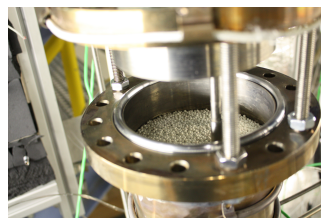
Energiespeicher mit Füllkörpern
