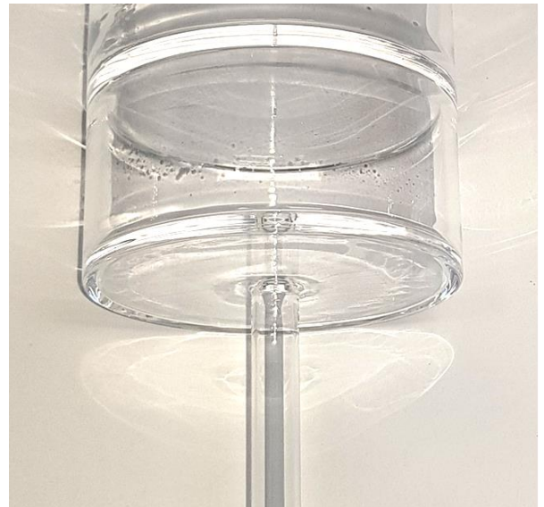
Abbildung 1: Vorkammer eines Flüssigmetall-Blasensäulenreaktors.
