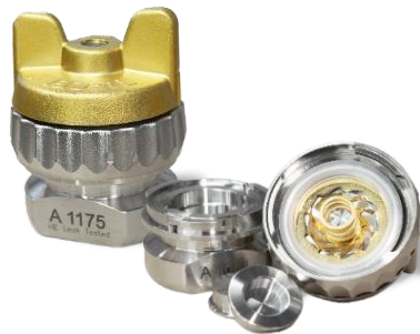
Abbildung 1: Experimentalzellaufbau zur Untersuchung des Batterieverhaltens
