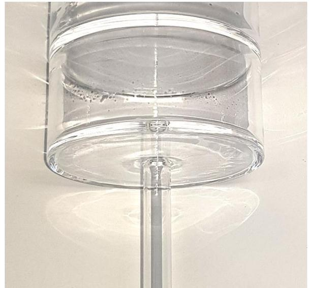
**Abbildung 1:** Vorkammer eines Flüssigmetall-Blasensäulenreaktors.
