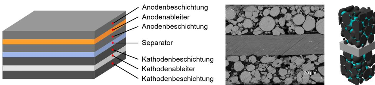
Abbildung 1: Links: Schematischer Aufbau einer Einheitszelle, Mitte: SEM-Aufnahme eines Kathodenstacks, rechts: CAD-Darstellung eines Elektrodenstacks.
