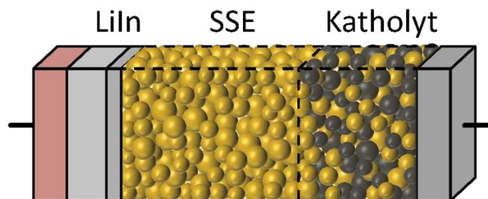
Abbildung 1: Schematischer Aufbau einer ASS-Batterie
