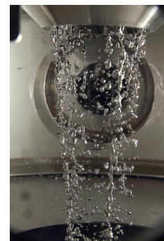
Abb. 1: Geschwindigkeitsverteilung einer Rohrströmung beim hydrodynamischen Einlauf (links); Freistrah­l einer Flüssigmetallströmung (rechts)
